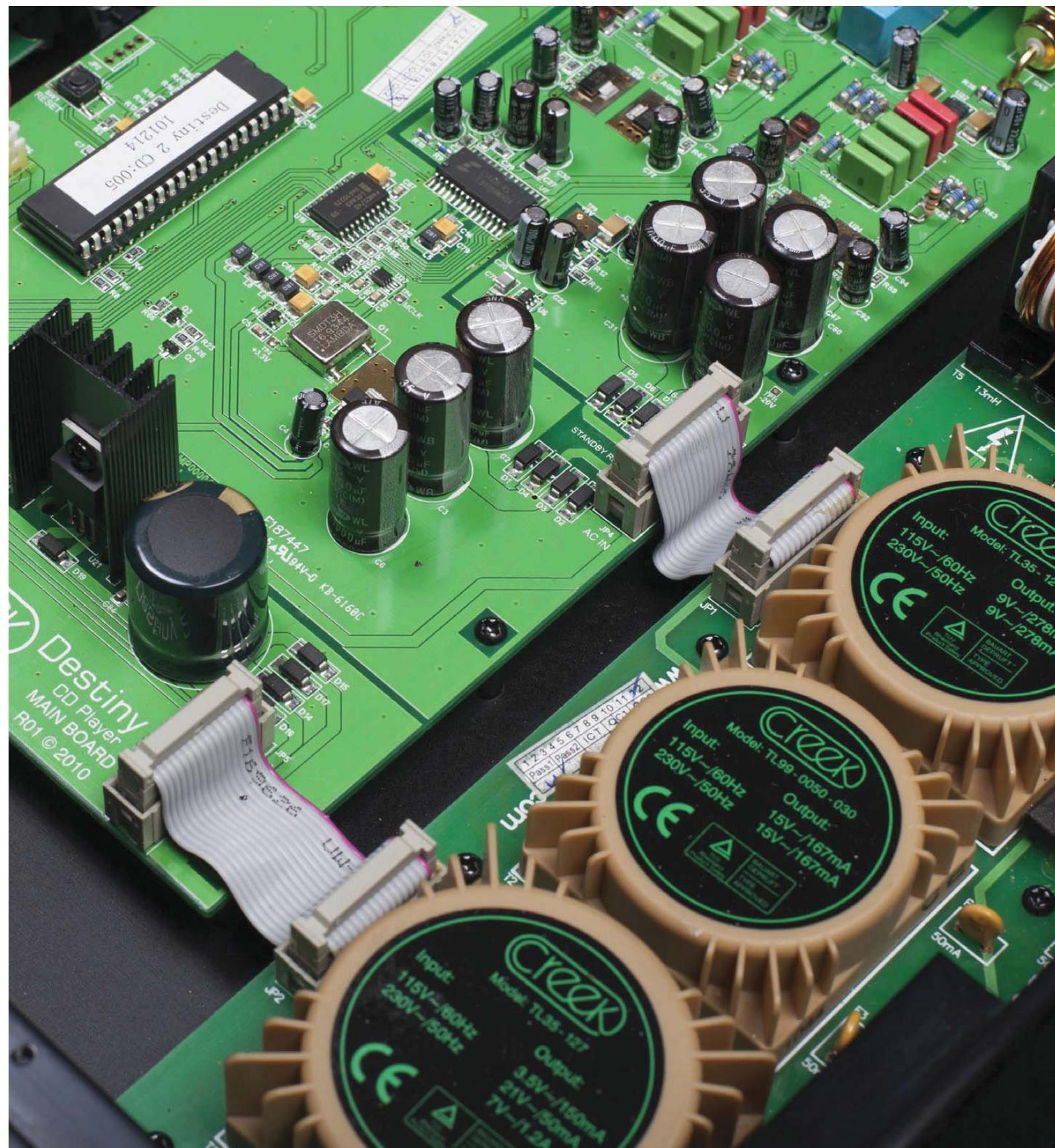
Блок питания усилителя построен на основном тороидальном трансформаторе номиналом 300 ВА, дополнительном на 50 ВА и банке фильтрующих конденсаторов суммарной емкостью 44 тысячи мкФ. В выходных каскадах, выполненных по каскодной схеме, установлены 4 пары полевых N-канальных транзисторов от **International Rectifier**, *IRF3711Z* и *IRFB52N15D*. Автор разработки – вышеупомянутый Алекс Никитин.
